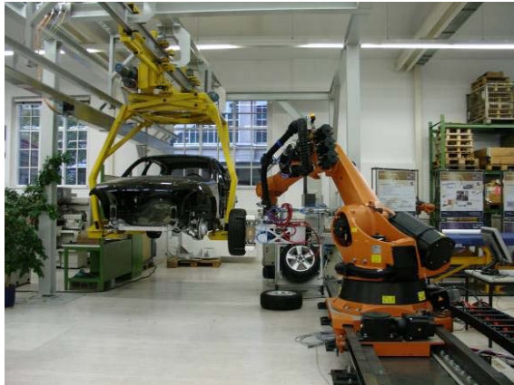
Bild 1: links: Gesamtanordnung zum Anbau von Rädern an bewegte Fahrzeuge rechts: Endeffektor mit Greifern, Schraubern und Kamera mit Ringleuchte im Zentrum
